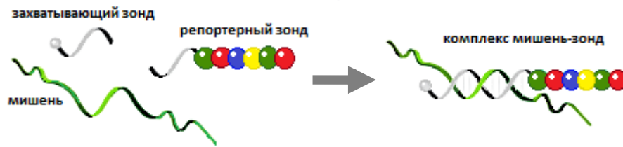
Рисунок 3 – Принцип работы NanoString, основанный на методе «молекулярных штрих-кодов» – цифровом обнаружении и прямом молекулярном штрихкодировании молекул-мишеней за счет использования таргетной пары зондов (репортерного / флуоресцентного и захватывающего для иммобилизации на поверхности чипа)
